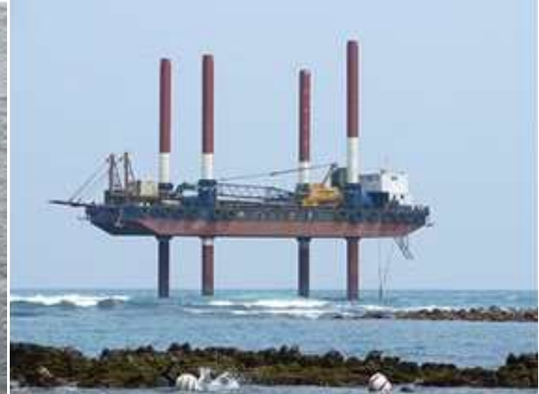
그림 2 건설공사용 SEP 바지(Barge)선
