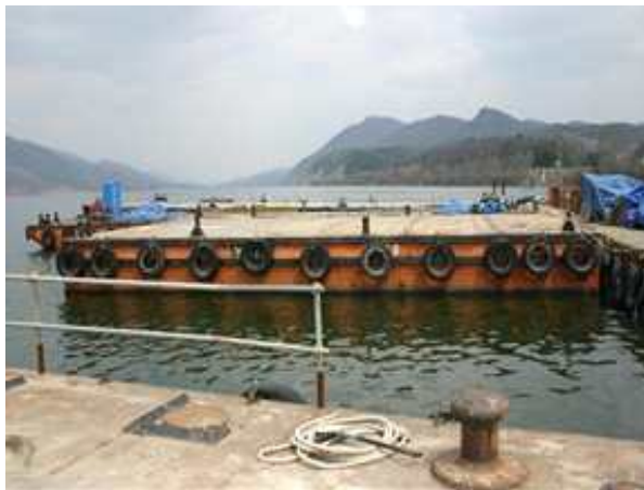
그림 3 건설공사용 바지(Barge)선
